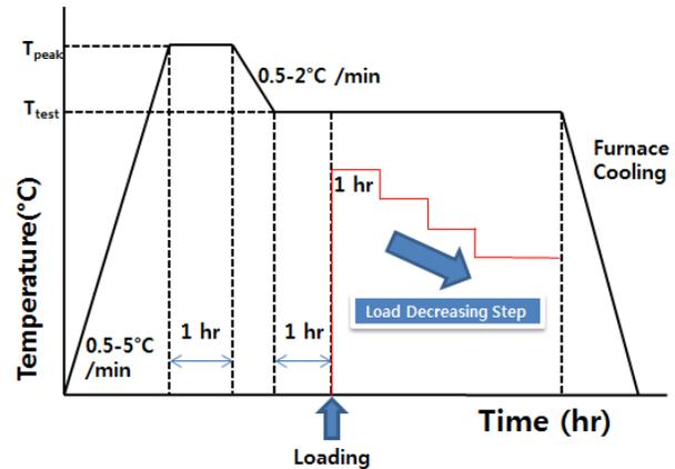
Fig. 3. DHC test procedures.
